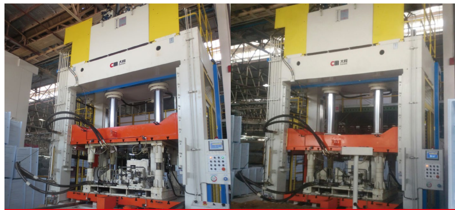
冰箱内胆专用打孔 及裁边油压机
